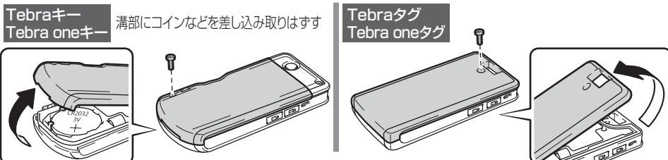
**3 ドライバーなどをすき間に差し込み、起こすようにして古い電池を取りはずします。**
