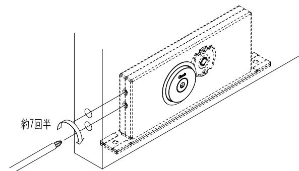
注1：止めねじを回し始めてすぐに固くなった場合はシリンダー・サムターンが正しく取付けられていませんので再度止めねじを緩め、4からやり直して下さい。
