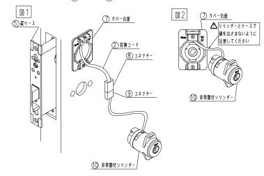
● 線を扉内にしまったら、仮置きしていた錠ケース (5)を取付ネジ (12) で緩く締め付けください。 ・その後、取付ネジ(12)を強く締めてください。
