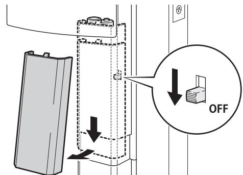
**2** 室内側から電池内蔵部のカバーを取りはずします。
