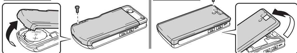
**3 ドライバーなどをすき間に差し込み、起こすようにして古い電池を取りはずします。**
